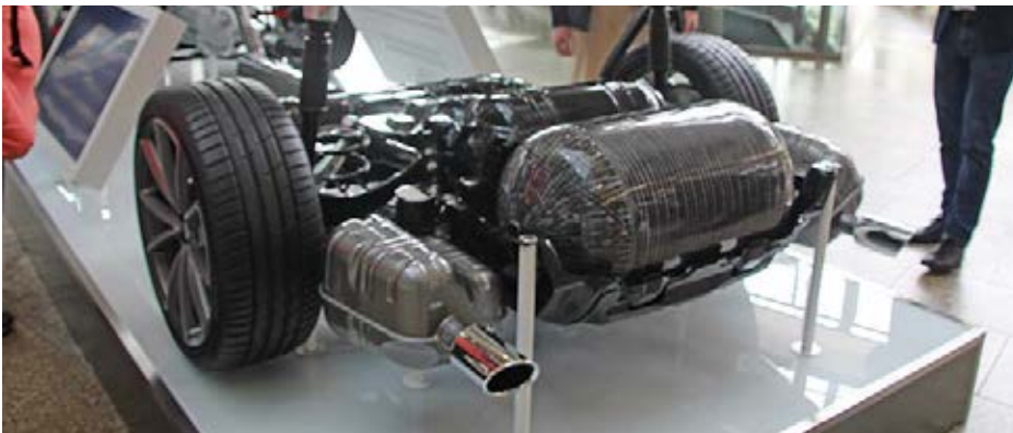
Le châssis d'une A4 g-tron avec ses deux réservoirs de gaz à l'arrière.
