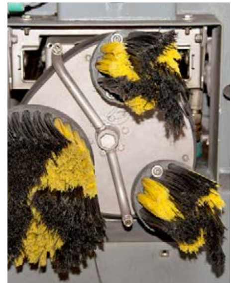
Kärcher conçoit un produit breveté à trois brosses circulaires rotatives pour nettoyer les jantes.
