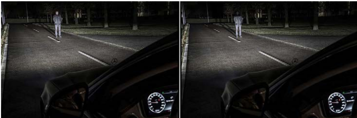
Certaines parties peuvent être masquées de façon ciblée : le piéton de la photo de droite n'est pas ébloui.
