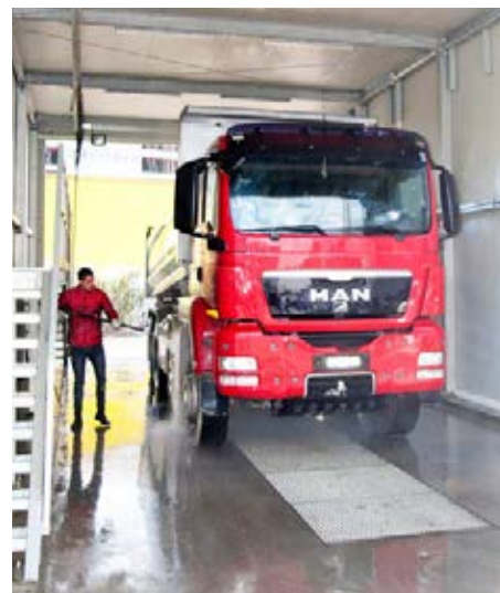
La passerelle sur l'installation de lavage pour camions permet un nettoyage sans effort du toit ou de l'intérieur du véhicule.
