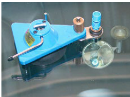
Bild 3. Montagebrücke mit aufgesetztem Injektor. Mithilfe des innen befestigten Spiegels kann der Füllgrad mit Harz besser beobachtet werden.
