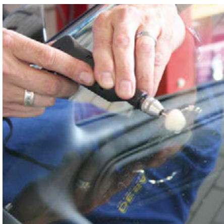
Bild 6. Zum Abschluss wird die reparierte Stelle noch poliert.
