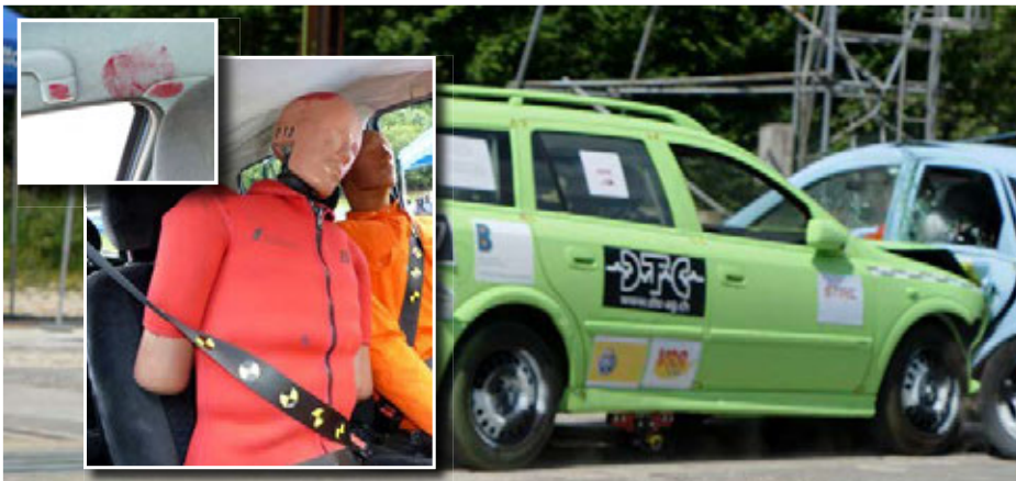
Mit 50 km/h in das stehende Fahrzeug. Der Beifahrer rutscht beim fahrerseitigen Aufprall aus dem Dreipunktgurt. Am Dachhimmel und der B-Säule sind die Spuren des Beifahrerkopfs gut sichtbar.
