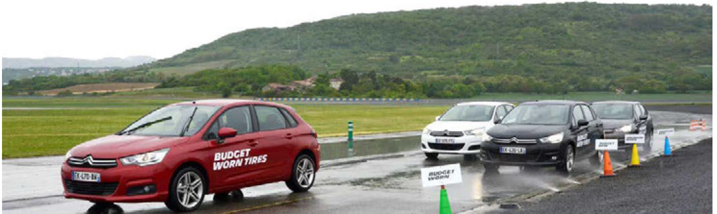
Der Bremsweg auf nasser Fahrbahn ist bei gebrauchten Reifen länger als bei neuen. Bei Premiumreifen (weisser und grauer Wagen) ist der Unterschied aber klar geringer.
