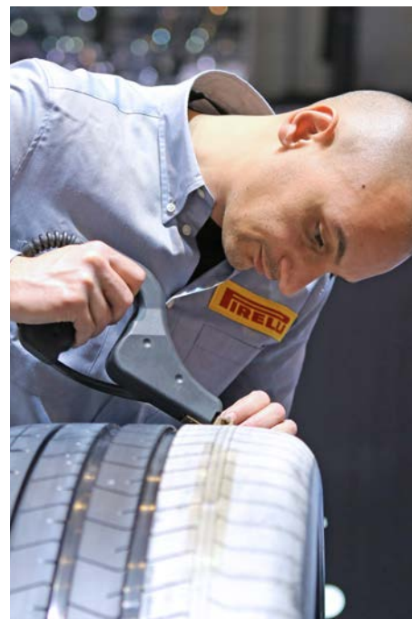
Un concepteur de pneus a sculpté le profil en direct et à la main dans le caoutchouc, de la même manière que Pirelli fabrique ses prototypes.
