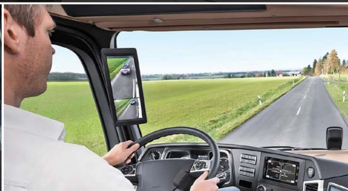
Des caméras et des écrans à la place des rétroviseurs : plusieurs constructeurs et sous-traitants ont présenté des produits qui vont bientôt sonner le glas des rétroviseurs latéraux traditionnels, au profit d'une sécurité et d'un aérodynamisme améliorés. Jusqu'à huit caméras installées sur le camion filment les angles morts et la zone directement à l'avant du capot, que le conducteur ne voit pas ou très peu. Les images sont diffusées sur de grands écrans dans l'habitacle. Les caméras-rétroviseurs, plus aérodynamiques que les rétroviseurs extérieurs dont la forme rappelle parfois un plateau, permettent de réduire la consommation de carburant entre 1 et 2%.
