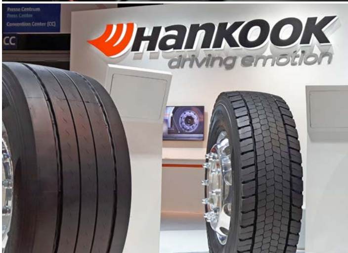
Le fabricant de pneus Hankook a présenté en exclusivité à l'IAA un jeu de pneus long courrier à faible résistance au mouvement, classé A pour la résistance au roulement sur toutes les positions d'essieu. Le pneu basse consommation E-Cube Blue doit permettre, selon son fabricant, une diminution de la consommation de carburant de l'ordre de 8%.
