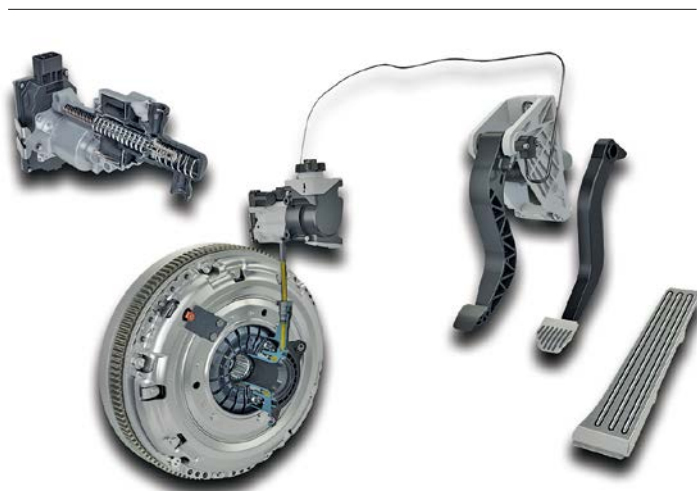
Fig. 1. MTplus est placé entre le cylindre émetteur et le cylindre récepteur. En haut à gauche, l'actuateur d'embrayage.
