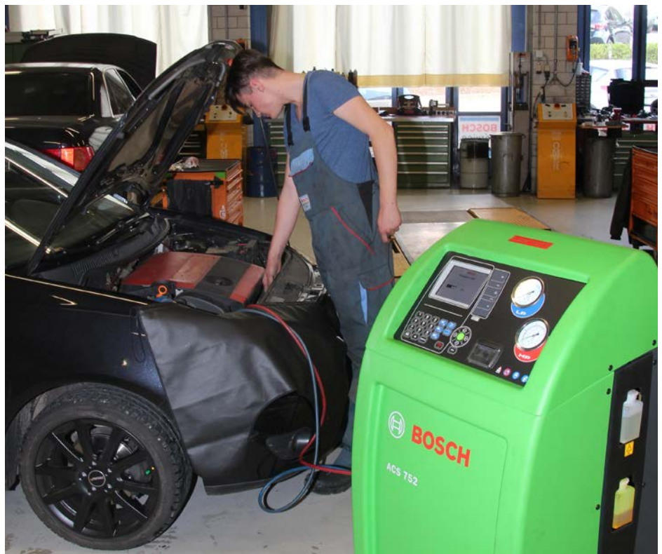
Almin Bejtic, apprenti mécanicien en maintenance d'automobiles, cherche à déterminer pourquoi la clim de cette VW Polo est en panne.
