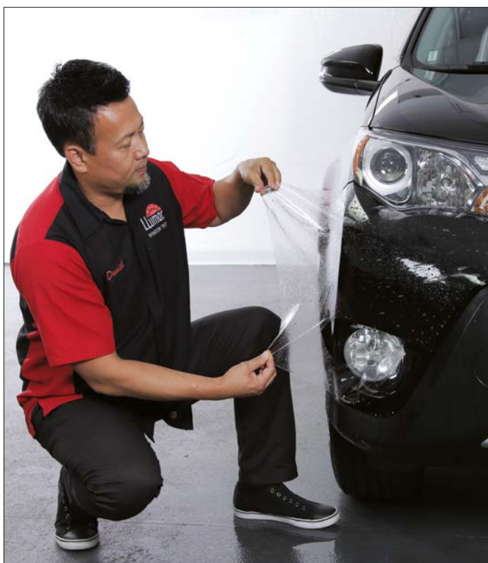
Un film protège la peinture des petits impacts de pierres, des rayons du soleil ou du sel de déneigement.
