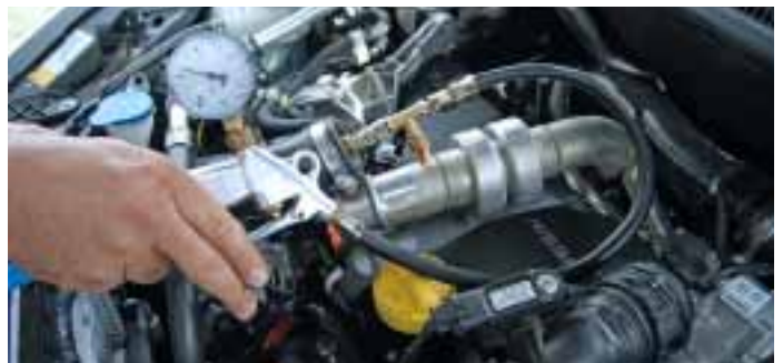
Bild 5. Mithilfe des Reifenfüllmessers wird das Ladeluftsystem unter Druck gesetzt, wobei der Überdruck 1,3 bar nicht überschreiten darf.
