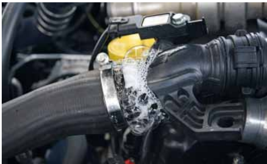
Bild 1. Undichtigkeiten können mit Leck-Such-Spray oder einer Seifenlösung sichtbar gemacht werden.
