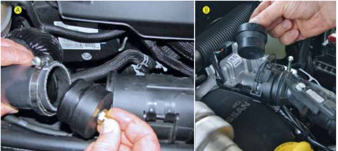
Bild 3. Die zwei Ausführungen der Verschlussstopfen: A Für die (herkömmliche) Befestigung mittels Schlauchschellen, B Für die Befestigung mittels Klickverschluss.
