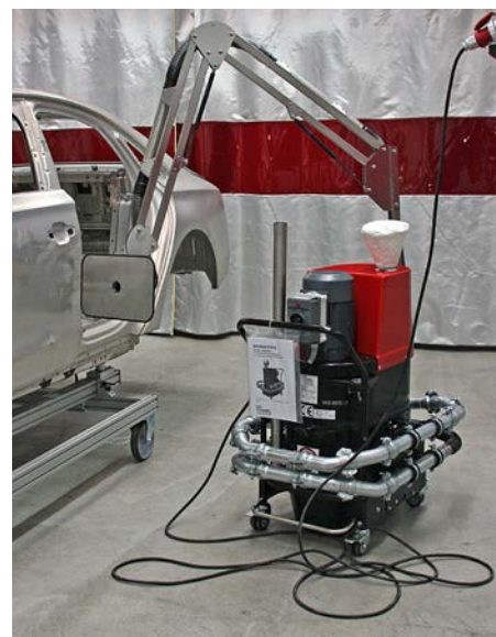
Der Sauger darf nur für Arbeiten an Aluminium- und Kunststoffcarrosserien und -komponenten verwendet werden.
