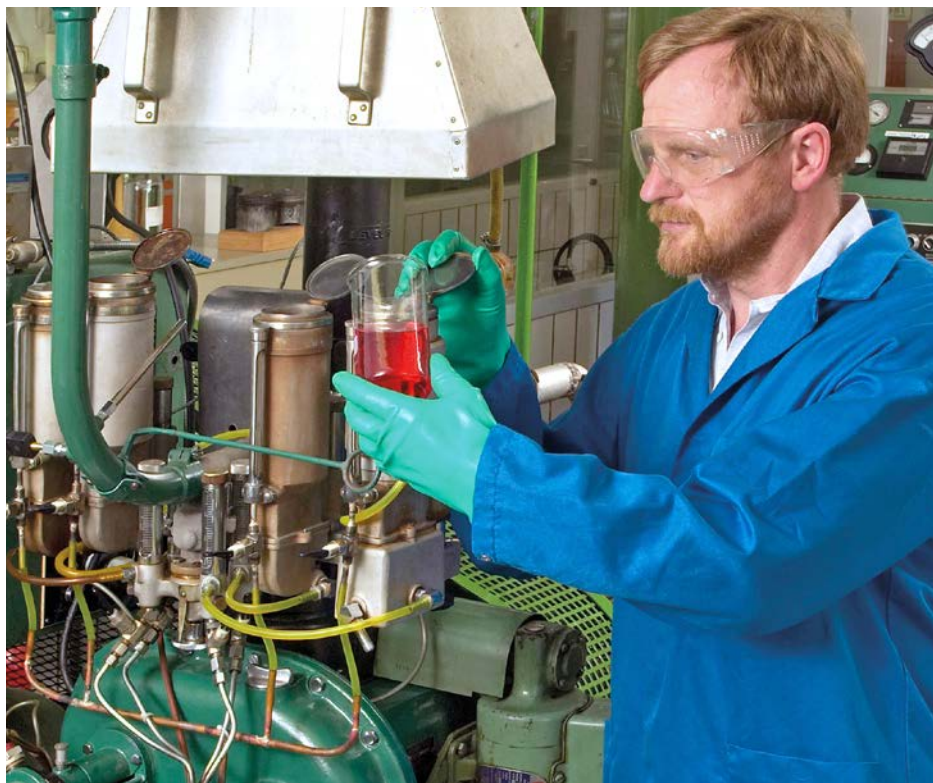
Bild 1: Der CFR-Prüfmotor, mit dem die Oktanzahl ermittelt werden kann.
