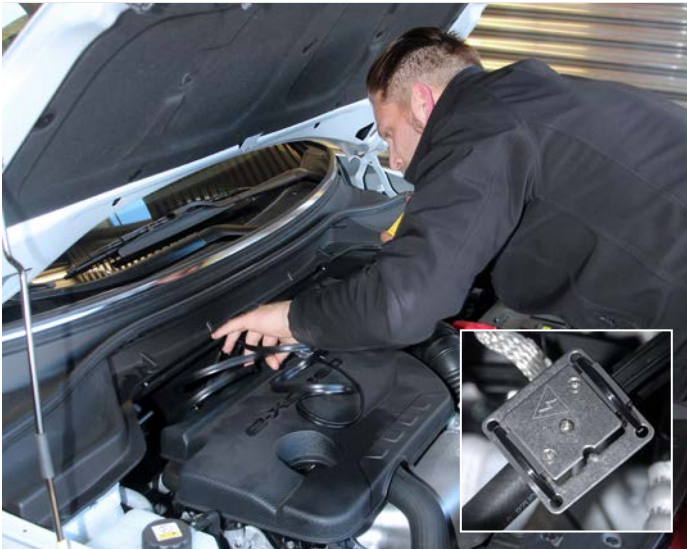
Stefan Schälchli verteilt die Kontaktplatten (kleines Bild) im Motorraum.
