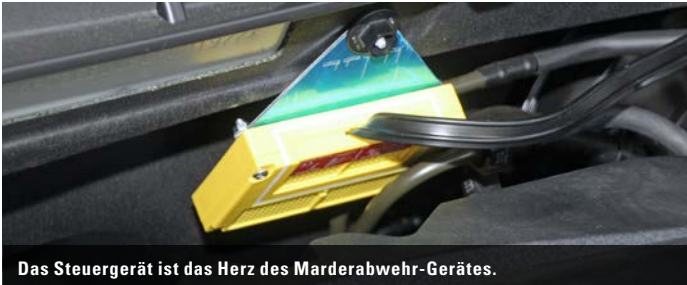
Das Steuergerät ist das Herz des Marderabwehr-Gerätes.
