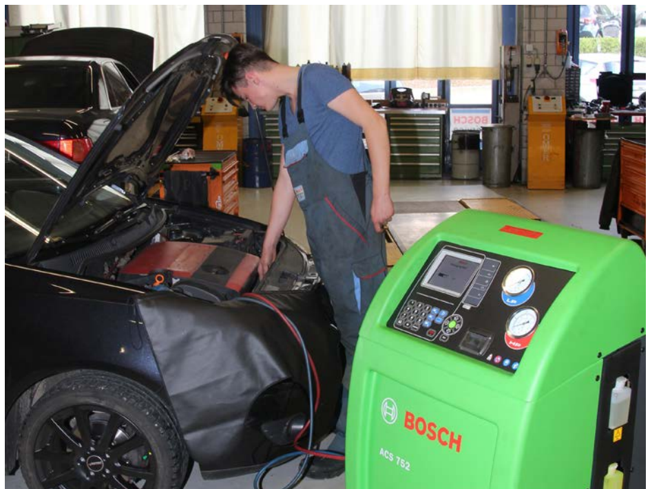
Der Automobilfachmann-Lernende Almin Bejtic versucht herauszufinden, warum die Klimaanlage dieses VW Polo streikt.
