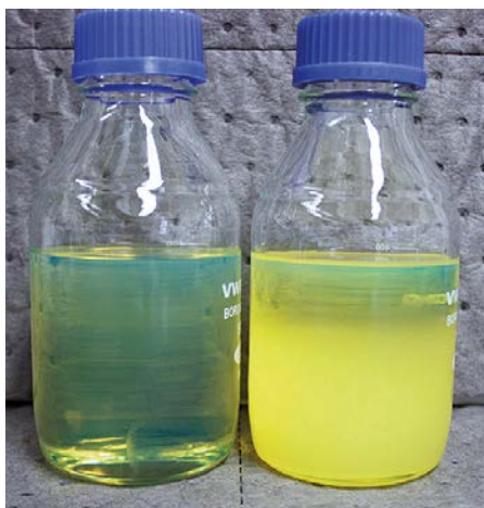
Bild 4. Auf eine Temperatur von -20 °C abgekühlter Winterdiesel (li.) und Sommerdiesel (re.) → beim Sommerdiesel hat sich das Paraffin grösstenteils ausgeschieden.
