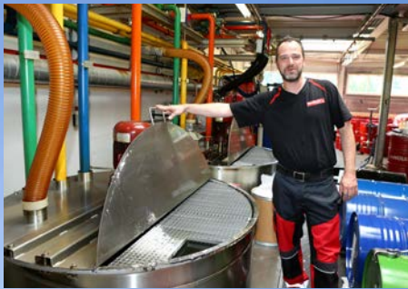
Stephan Lämmle vor der Mischanlage mit den drei 6000 Liter fassenden Tanks.
