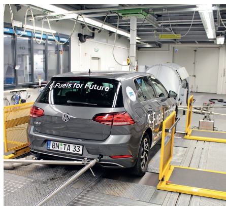
Les premières mesures au banc d'essai le montrent clairement: les véhicules à combustion fonctionnant avec des carburants électriques sont aussi propres que ceux fonctionnant avec des carburants fossiles. Pour respecter les limites d'émission, il faut continuer à miser sur un post-traitement des gaz d'échappement coûteux. Photo: ADAC
