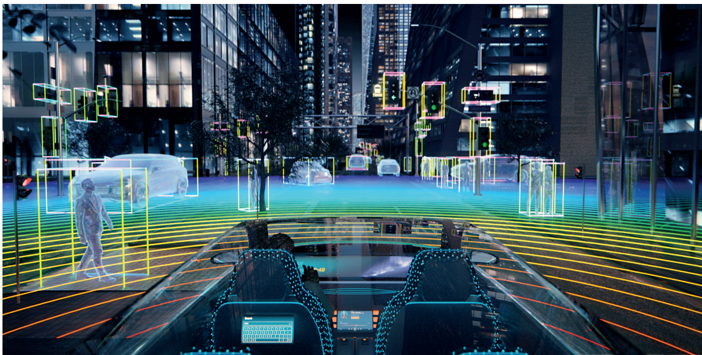
Umfeldsensorik sowie Kamerabilder verschmelzen zu einer digitalen Umgebung. Die Maschine erfasst die Verkehrssituation umfassender als der Mensch. Foto: Osram
