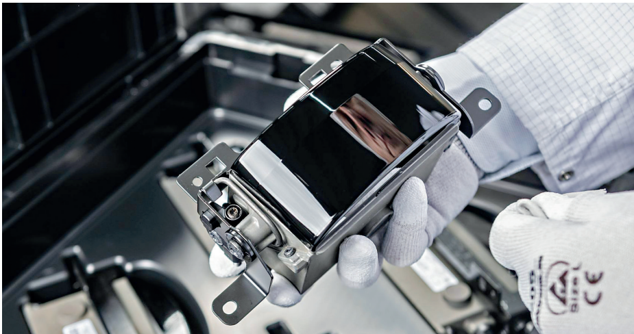
Voraussetzung für zusammengesetzte Umfoldsichten sind kleine Fischaugenkameras. Foto: Continental
