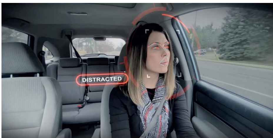
«Big Brother is watching you»: Modernste FAS überwachen die Fahrerin oder den Fahrer kontinuierlich und sind notwendig, wenn teilautonome Systeme wie Autobahnassistenten verbaut werden. Foto: Magna
