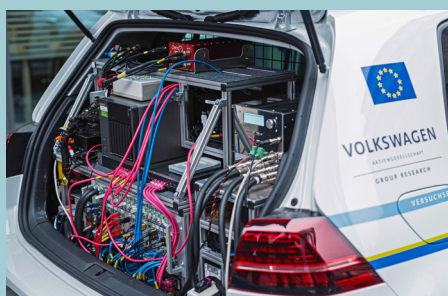
Le matériel d'évaluation des capteurs prend beaucoup de place sur les véhicules de recherche. Source: VW
