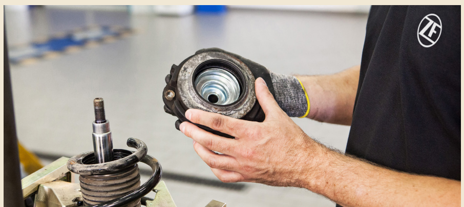
Diagnostiquer et remplacer les pièces usées comme les coupelles d'amortisseurs fait partie des principales tâches dans le contrôle des châssis. (Photo : ZF)
