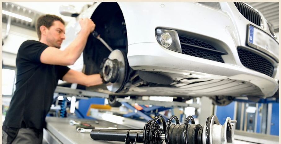
Le châssis assure la liaison entre les roues et la carrosserie. Pour les travaux effectués sur les châssis, la tolérance d'erreur est de 0 %. Le potentiel de risque des ressorts hélicoïdaux précontraints, qui doivent être sécurisés lors du démontage à l'aide d'un tendeur de ressorts, est sous-estimé, notamment par les bricoleurs amateurs. (Photo : ZF)
