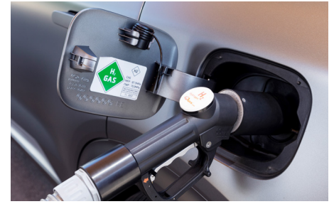
Pour les propriétaires de véhicules à hydrogène, faire le plein est simple : l'hydrogène gazeux remplit le réservoir de 700 bars en cinq minutes. Image Hyundai.
