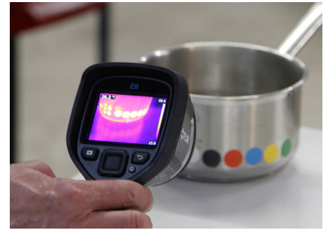
Les surfaces métalliques lisses ont une émissivité basse et réfléchissent davantage d'énergie thermique qu'elles n'en émettent. Les textiles à la surface rugueuse renvoient l'énergie de rayonnement avec précision.
