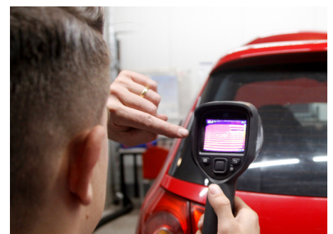
Le dégivrage de la lunette arrière fonctionne-t-il bien partout ? La thermographie permet de visualiser la performance du chauffage ou le courant passant à travers les fils conducteurs.
