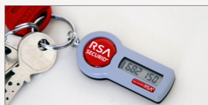
Wechselpasswörter garantieren, dass nur authentifizierte Personen Diagnosen und Updates durchführen. (Quelle: Se)
