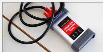
Der SAE-Standard J2534 beschreibt die Verbindung des OBD-Adapters. Die Hardware muss vom Automobilhersteller freigegeben werden, damit die Diagnose oder Softwareupdates reibungslos möglich sind. (Quelle: Se)
